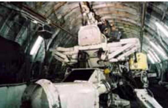
Richtungsweisende Technik. 2001 wurde die Streckenvortriebsmaschine AVSA im Flöz Matthias 2 erstmals eingesetzt.
